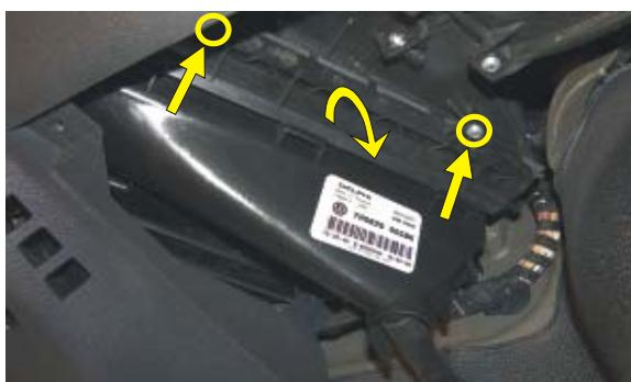
**(PL)** Odkręcić wkręty mocujące pokrywy komory filtru. Zdemontować osłonę komory filtru
